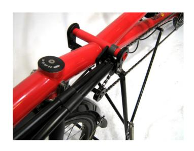
Die hinteren Streben werden mit M6 Schrauben und Distanzhülsen befestigt, wie im Bild rechts zu sehen. Jetzt ist der Ständer einsatzbereit.
