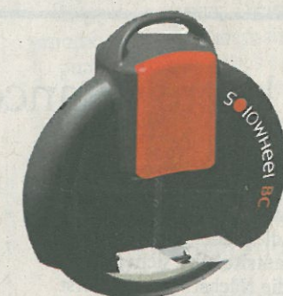
Der Fahrer des kompakten Solowheel lenkt, indem er sein Gewicht verlagert
