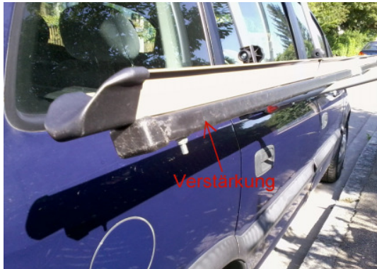
Abb.: Verstärkung Schiene
